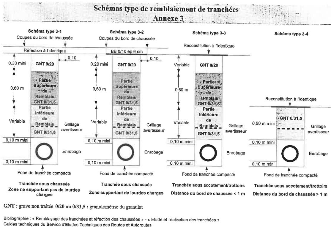
– Schéma 3-2 : Schéma de remblaiement de tranchées pour zones supportant des charges lourdes
